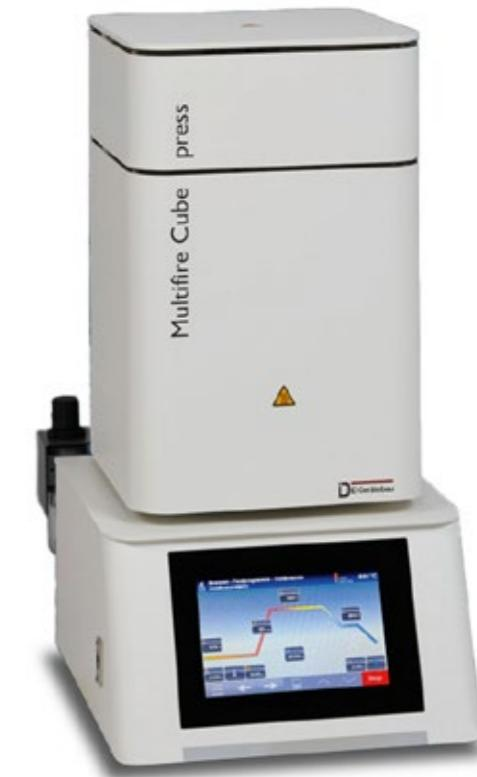
Seine exzellenten Resultate erzielt der Multifire® Cube press unter anderem durch seine Besonderheit der vertikal verfahrenden Brennkammer: Die zahntechnische Arbeit verbleibt vibrationsfrei auf dem Brennsockel, da sich nicht der Objekträger, sondern die Brennkammer bewegt. Die pneumatische Press-Funktion ermöglicht zusätzlich die Erstellung hochwertigster zahntechnischer Arbeiten aus Vollkeramik.
